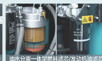
油水分离一体型燃料滤芯/发动机油滤芯
